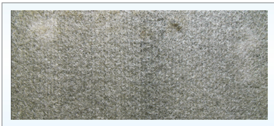
Foto 25: Lado máquina do feltro com presença de contaminantes (mancha escura)
