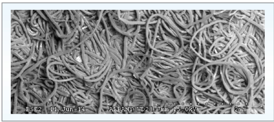
Foto 32: Face inferior do feltro retornado com presença de contaminantes
